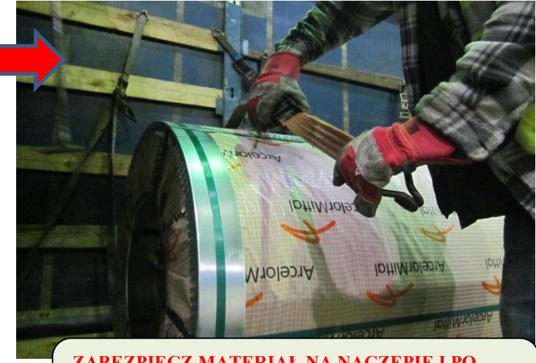
ZABEZPIECZ MATERIAŁ NA NACZEPIE I PO UZYSKANIU ZGODY PRACOWNIKA WYSYŁKI WYJEDŹ Z HALI
